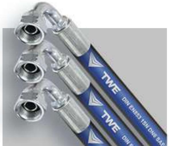
Quando esse trançado é de fio de aço latonado de alta tenacidade, essa mangueira pode ser usada para média e alta pressão. Esse tipo de reforço pode ter de uma a três camadas, e sempre separado por uma camada de borracha adesiva para evitar atrito entre as camadas.
